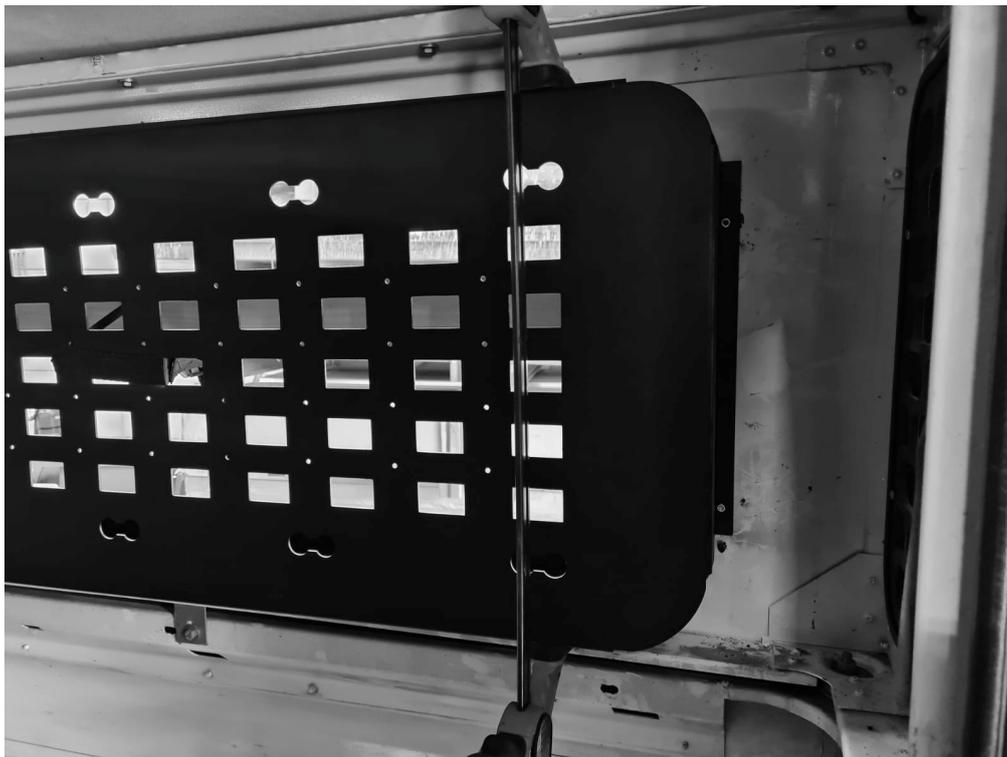
4. Bevor Sie die Montagelöcher des Seitenklappfensters übernehmen, prüfen Sie, ob die Staubox aufgrund des begrenzten Montageraums rundum gut am Fensterprofil anliegt.
