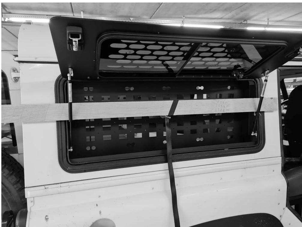
3. Klemmen Sie dann die Staubox auf der Innenseite senkrecht an zwei Stellen mit einer Spannzange fest.
