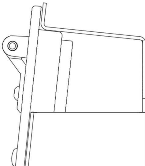
5. Kopieren Sie nun das Lochbild des Seitenklappfensters mit einem 4,2 mm Bohrer. Wir empfehlen, unmittelbar nach dem Bohren jedes Lochs eine M4 x 20-Schraube zu montieren und die M4-Mutter einige Umdrehungen anzuziehen. Auf diese Weise kann sich die Box nicht mehr bewegen.
